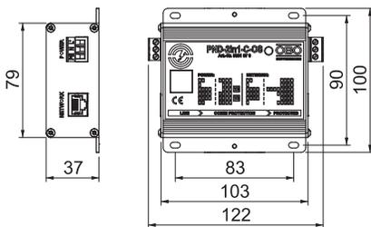
Anwendung: Zum Schutz von CCTV, Videosignalen; (IP-)Kameras bzw. TV- Anlagen
