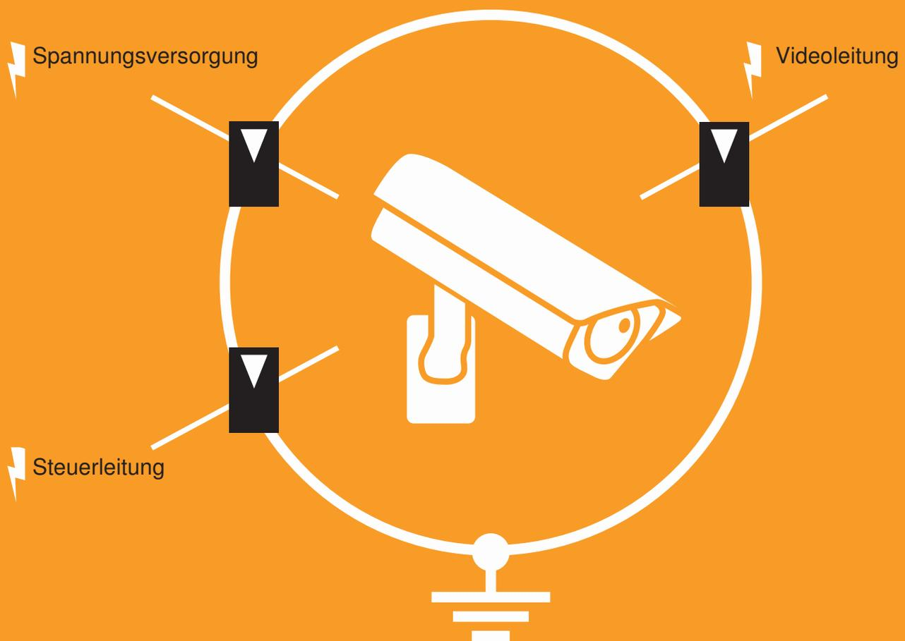
Zur Erfüllung eines umfassenden Überspannungsschutzkonzeptes müssen alle stromtragfähigen Teile eines Endgerätes bzw. einer Einrichtung in den Potentialausgleich eingebunden werden. Im Falle von Kamerasystemen sind dies die unterschiedlichen Schnittstellen, über die die Kamera verfügt. Je nach Ausführung schwankt die Anzahl von einer bis drei.
